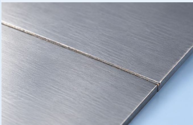
薄壁金属接缝焊接
